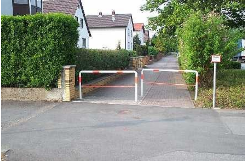
Beispiel einer Umlaufsperr
